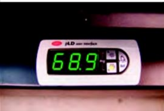
Pantalla de temperatura e interfaz de punto de referencia para SmartAire y PowerAire
